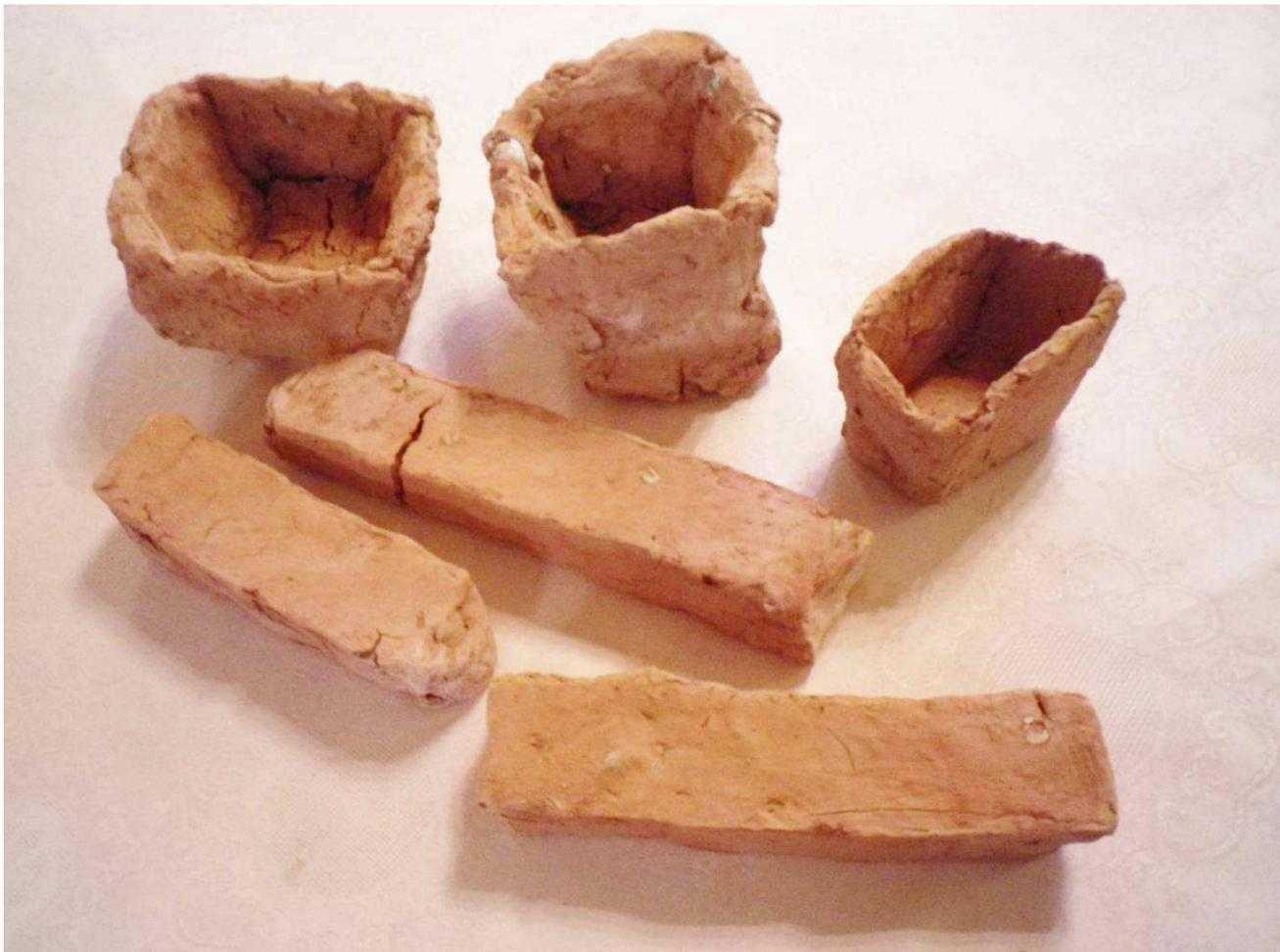
*Pièces réalisées avec de l'argile prélevée à 3 mètres de profondeur dans le marais (cuisson au four à gaz).Cet argile noire, considérée comme bonne par Robert Sourice du Fuilet, donne après cuisson des pièces légères*
