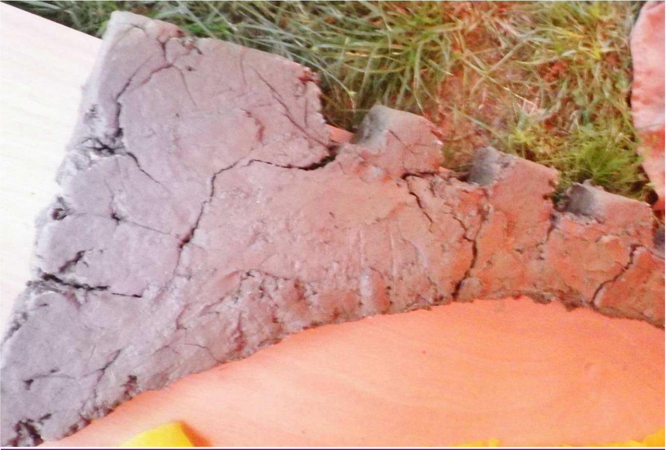
*Lors du séchage, la fissuration de l'argile des pièces épaisses que sont les voutains pose toujours problème à l'Association P2MB. Il y a un retrait de 5 à 7%, probablement parce qu'on utilise de l'argile trop humide.*
