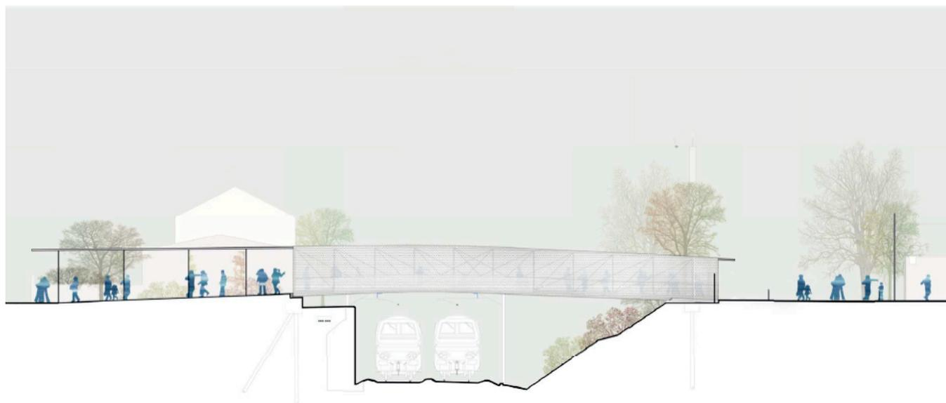
**Les matériaux :** la charpente métallique est réalisée à base de profilés fermés. Les assemblages ont été réalisés par soudage entre membrures en atelier. Cette charpente est réalisée en acier S355 avec protection anticorrosion. Quant à la partie tablier, elle est en acier autopatinable, qui, par sa couche naturelle de protection anticorrosion, ne nécessite aucun entretien durant toute la vie de l'ouvrage.
