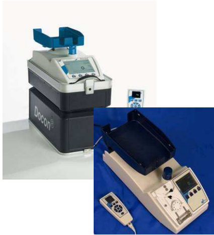
Lecteur RFID intégré au lecteur code barre du Docon Mobile II
