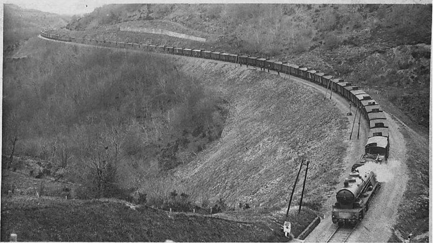
Train de marchandises de 1.500 tonnes sur pente de 35 ‰ (Ligne de St-Flour à Brioude). Equipé du frein automatique Westinghouse
