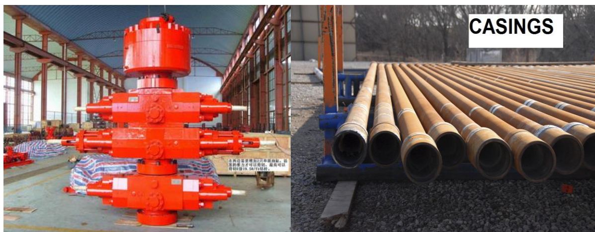
Tête de puits (fabrication française et tubages supérieurs
