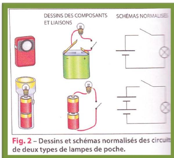
**Fig. 2** – Dessins et schémas normalisés des circuits de deux types de lampes de poche.
