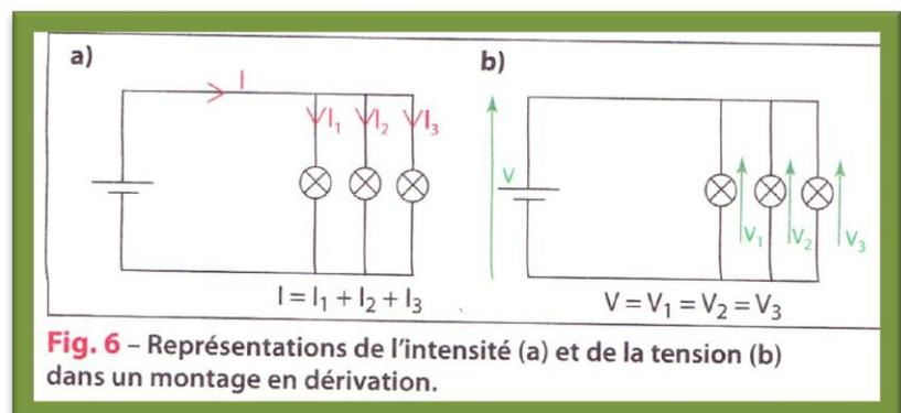
**Fig. 6** – Représentations de l'intensité (a) et de la tension (b) dans un montage en dérivation.
