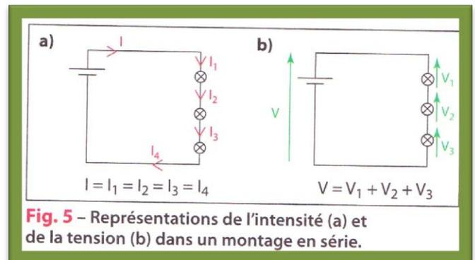
**Fig. 5** – Représentations de l'intensité (a) et de la tension (b) dans un montage en série.
