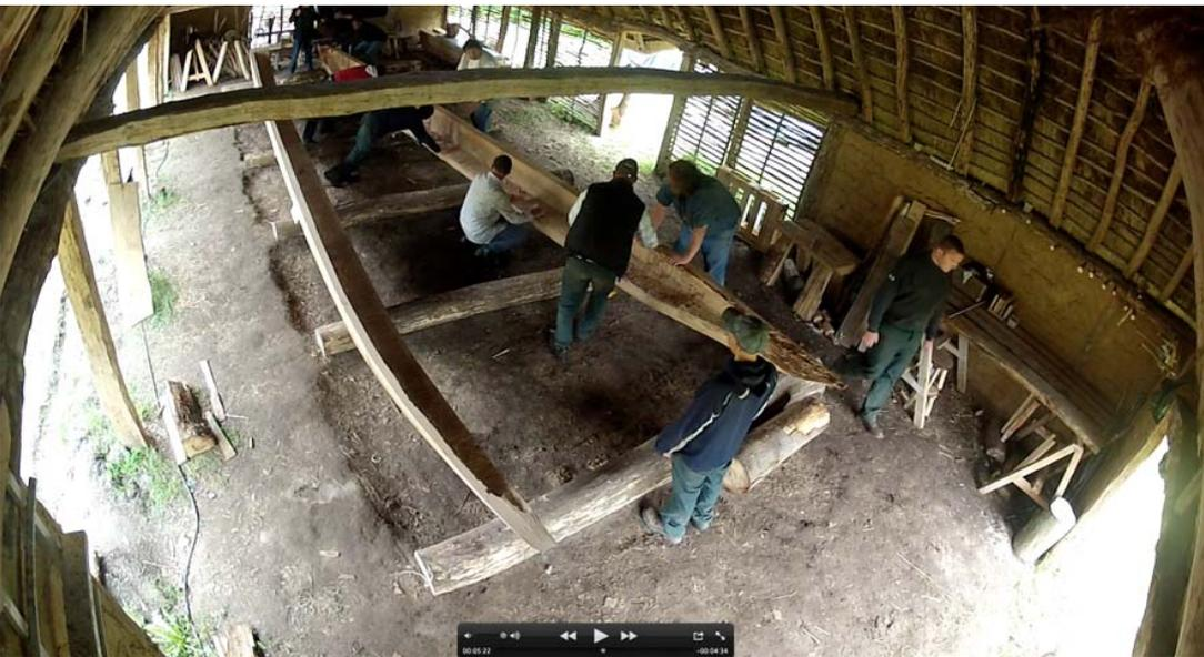
*Installation des bordés monoxytes sur leur chantier (extrait d'un film GoPro)*
