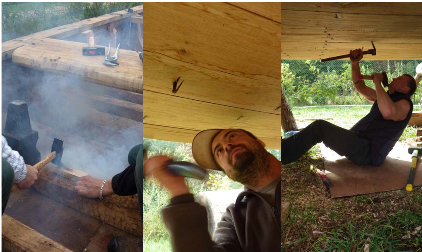
Le travail s'effectue simultanément à l'intérieur du bateau (plantage) et à l'extérieur (rabat des pointes en agrafes, préparation des encoches)
