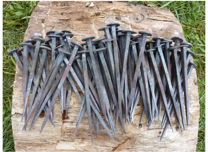
Une partie des 650 clous d'assemblage
