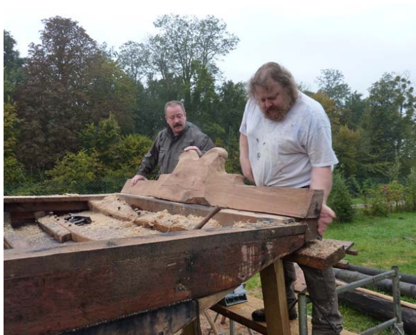
Pose du massif d'encastrement de l'aviron de gouverne
