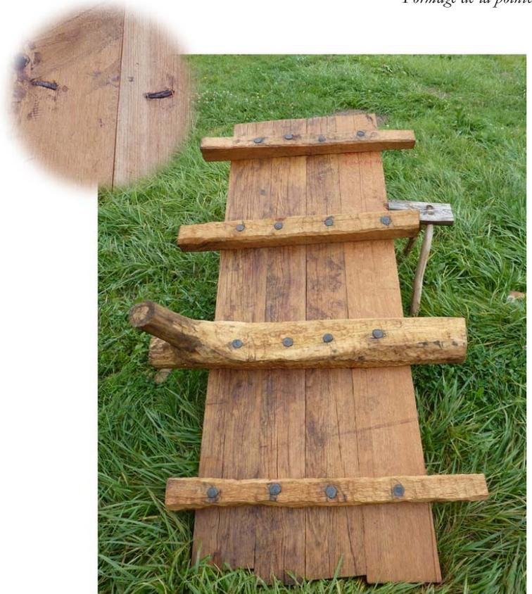
*Test de fixation. Les clous traversent les planches ; les pointes sont recourbées « en agrafe ».*
