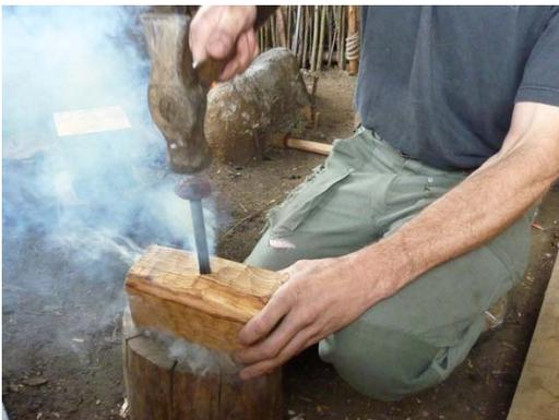
*Test d'enfoncement à chaud*
