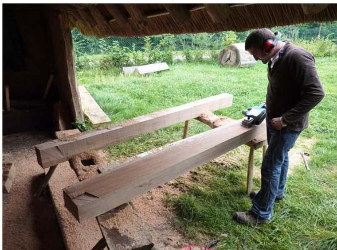
*Test de préforme des passavants (pièce du plat-bord située au passage de la cabine)*
