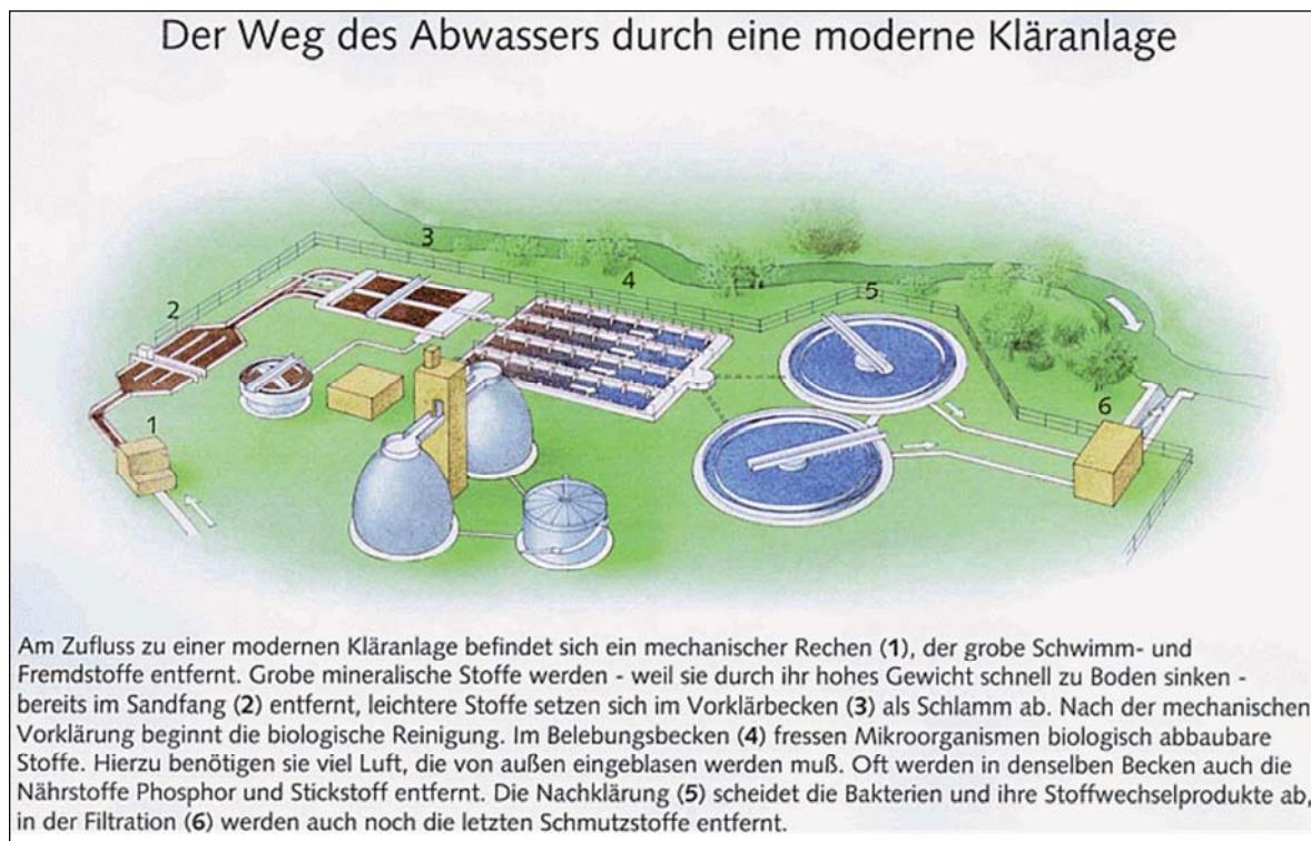
Abbildung 11.1.1: Aufbau einer Kläranlage (Quelle: Wasserwirtschaftsamt Kempten: www.wwa-ke.bayern.de )
