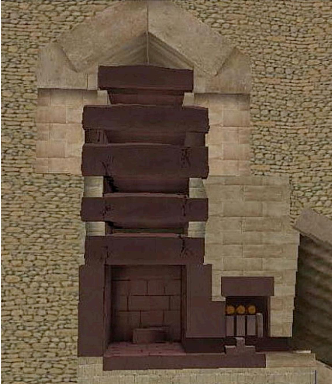
Les blocs de granit n'ont pas supporté la masse énorme et des fissures sont apparues. Cet incident n'a pas suffi à détruire la pyramide, c'est la seule et unique blessure du monument, excepté la démolition effectuée par les hommes.
