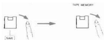
(4) Si le magnétophone présente une commande de niveau d'enregistrement, la régler de telle sorte que le signal pilote soit en proximité de 0 VU. En moins de cinq secondes, le JP-6 produira une tonalité modulée au lieu du signal pilote, c'est-à-dire que la sauvegarde par magnétophone débute). Il est recommandé de bien régler le niveau d'enregistrement avant d'entendre la tonalité modulée).
