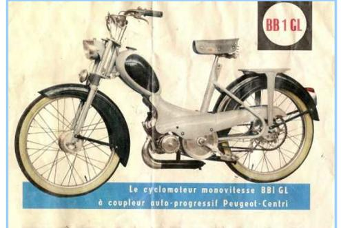
Le bloc moteur est inédit : le haut moteur et l'allumage sont celui des BB2, mais tout le reste est nouveau. Les carters sont en aluminium et ils intègrent la fixation inférieure et le support du stator. Le volant magnétique est également en aluminium. Le carburateur est un Gurtner D12.D453 sans cuve de décantation dont la prise d'air utilise le même système que le BB2 L (l'air est aspiré sous la selle par l'intermédiaire du tube de selle).
