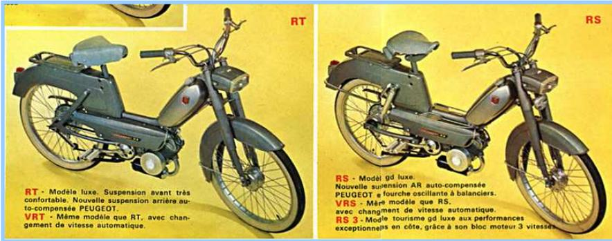
arrière est remplacé par une coque enveloppante qui intègre le système d'amortissement de la selle. Les caches moteurs ont été raccourcis par rapport au modèle **C**, **CT** et **LT**. Le **RT**, tout comme le **LT** est doublé d'une version à variateur : le **VRT**. Les roues sont toujours en 19 pouces sauf la roue arrière des versions sans variateur qui passe en 18 pouces.
