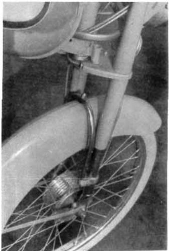
Suspension avant, notons sur la fourche un petit arceau de rigidité servant aussi de support de garde-boue.
