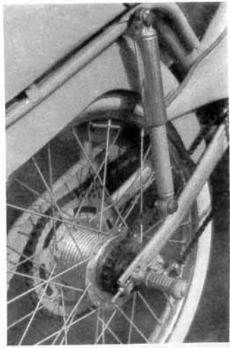
Suspension arrière, les repose-pieds obligatoires pour le transport d'un passager sont fixés sur l'axe de la roue arrière et assurent une bonne position des jambes.
