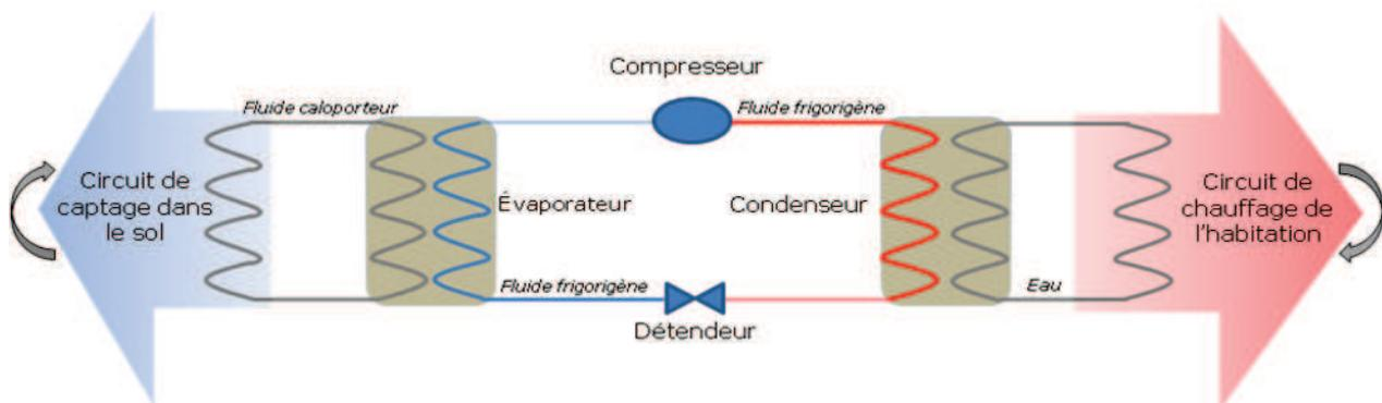
Figure 4 : Schéma d'un procédé à fluide intermédiaire
