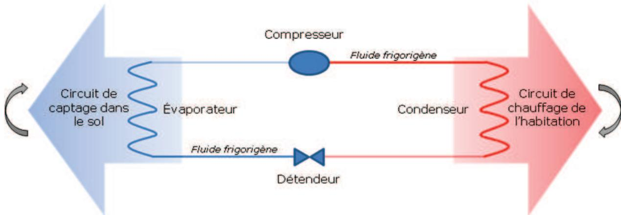
Figure 3 : Schéma d'un procédé à détente directe
