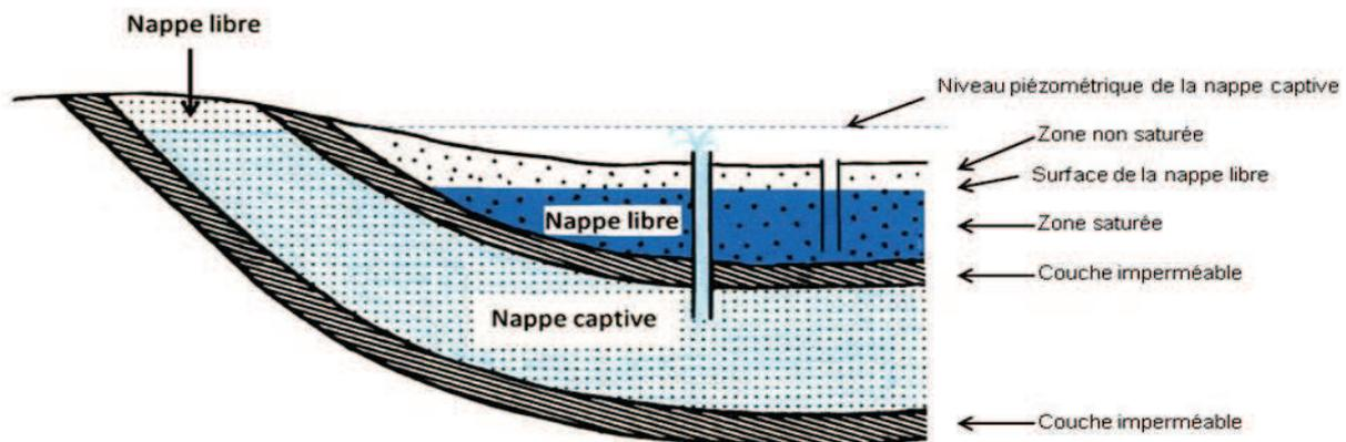
Figure 9 : Schéma représentatif des types de nappes et de leur vulnérabilité
