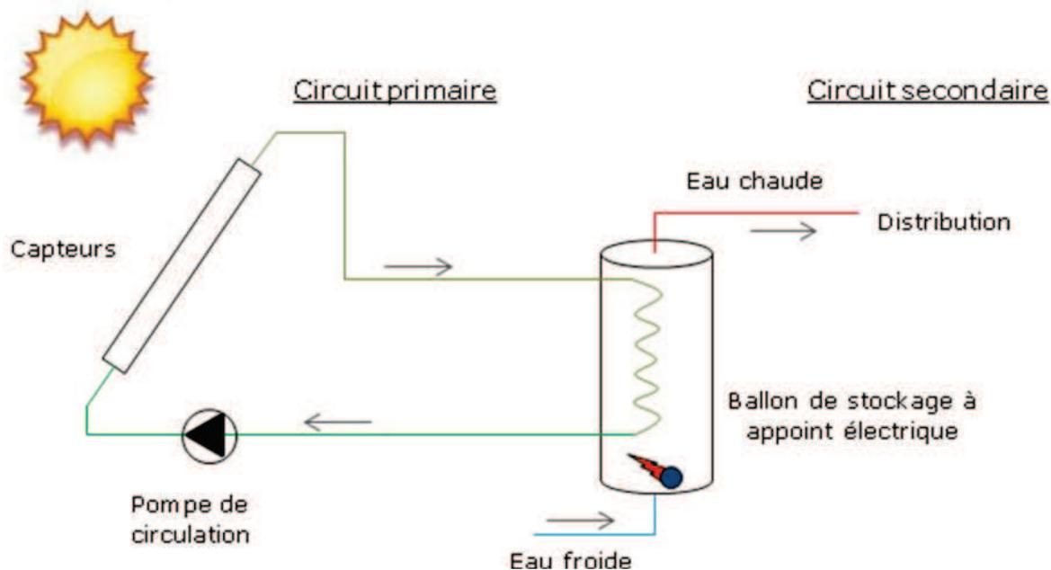
Figure 6 : Schéma simplifié d'une installation solaire thermique
