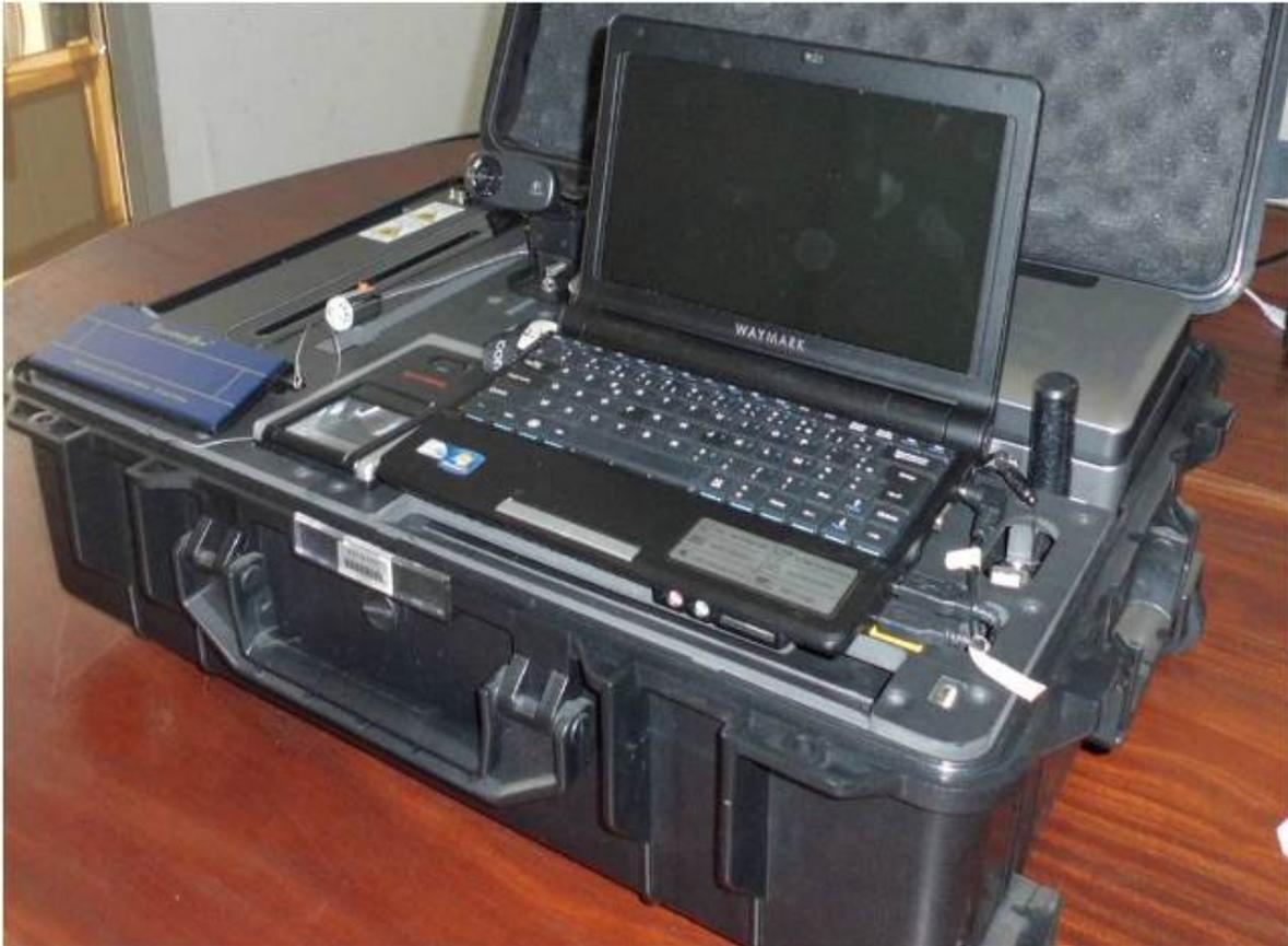
*Valise Waymark (Kit) comprend: un ordinateur portable, un lecteur biométrique d'empreintes digitales, une lampe, un scanner, une imprimante et un appareil photo. Le kit a été monté au 3ème étage de la Villa nommé (Site Central).*
