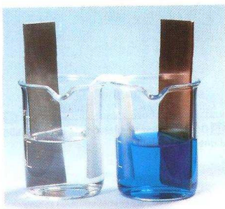
9 Jonction constituée d'un papier filtre imbibé d'une solution ionique (ou électrolyte).
