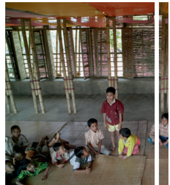
La grande salle de l'étage est destinée aux activités physiques. Son plancher est constitué de trois couches de tiges de bambou, disposées à plis croisés pour assurer le contreventement. Une couche de terre sur des planchettes en bambou sert de chape et de sol. The large room on the upper floor is intended for physical activities. Its floor comprises three layers of bamboo poles, cross-folded together for bracing. An earth layer on bamboo slats is used as a levelling and surfacing course.
