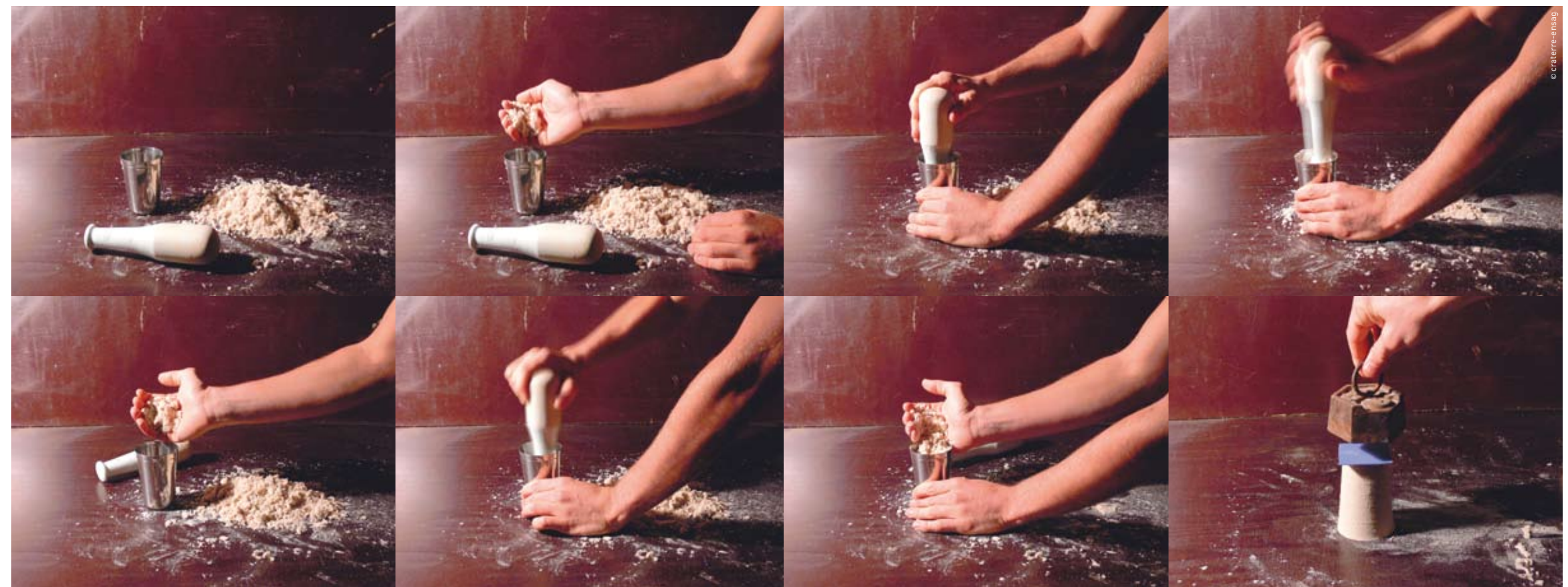
Résistance : l'expérience de ce château de sable permet de comprendre l'intérêt du compactage progressif du pisé : quand le contenu d'un gobelet tassé en une fois à la main ne résiste pas, une fois démoulé, à un poids de 500 g (dans une expérience précédente), celui-ci, rempli petit à petit en compactant de fines couches de sable les unes après les autres avec un semblant de psoir, supporte, une fois démoulé, un poids de 3 kg !
