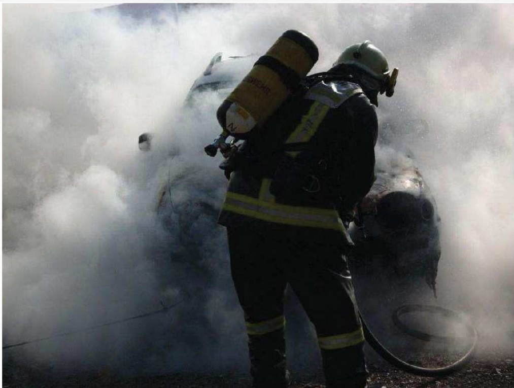
Extinction du feu crée par l'inflammation du fluide frigorigène 1234yf - Source: DUH
