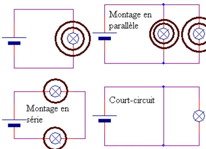
Dans un montage en parallèle, les ampoules éclairent normalement.
