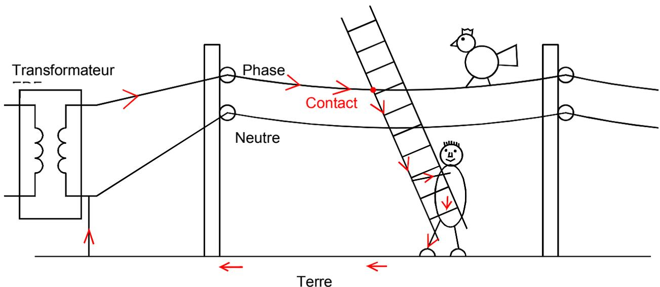
Un circuit électrique fermé est établi ; Il y a un générateur (ici c'est le transformateur EDF), un récepteur (malheureusement notre bonhomme) et un circuit. Le fil de phase, l'échelle métallique le bonhomme, la Terre, et le fil qui relie le neutre à la Terre. Notre bonhomme sera foudroyé.
