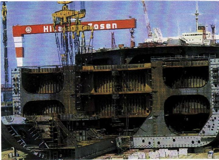
particularité d'être construit à double coque intégrale, sur le fonds et sur les bordés. Ce système, imposé de fait par les USA après la catastrophe de Exxon Valdez en Alaska, a
