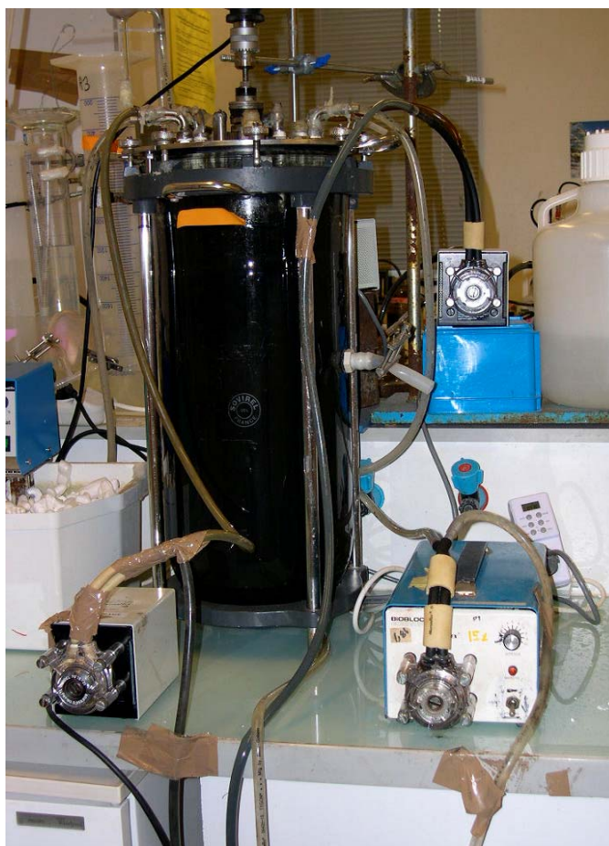
Figure D2. Réacteur de digestion anaérobie traditionnelle (R1).
