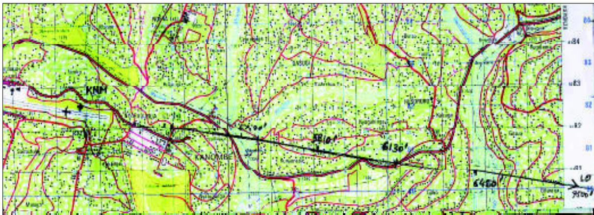
Le trait matérialise l'axe de l'approche tel qu'il est balisé par le faisceau radioélectrique de l'ILS (« Instrument Landing System »), nous avons reporté des altitudes de passage durant la descente sur un plan de 3 degrés, les chiffres indiqués sont des altitudes en pieds, c'est-à-dire calculées par rapport au niveau de la mer. Le tableau ci-dessous donne des hauteurs par rapport à l'altitude du point de référence de l'aérodrome de Kigali, à savoir 4891 pieds (1490,8 m)
