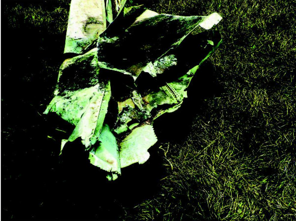
L'explosion de la tête du missile SA16 ou d'un autre type équivalent dans ce réservoir pouvait aboutir à ce résultat. Quelle a été la contribution du kérosène dans ce mécanisme explosif ? Voyons maintenant dans quelles conditions ce réservoir a pu exploser et comment s'est formée la boule de feu.
