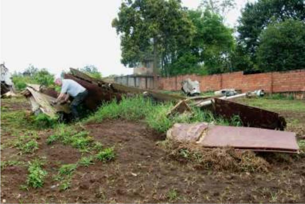
**Fig. 13 : Aile droite et partie arrière de l'aile gauche (4).**
