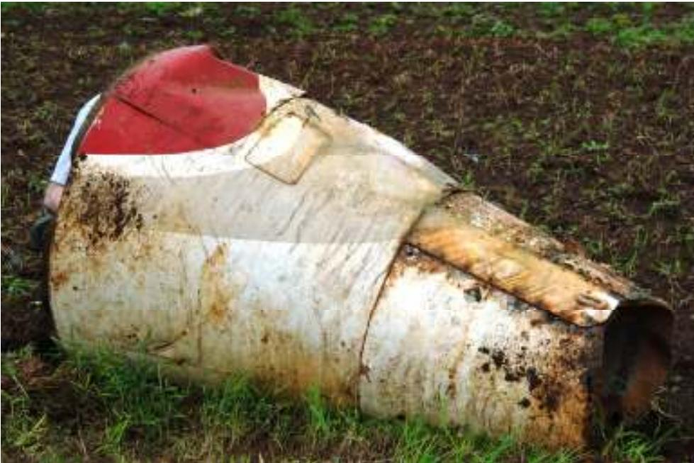
**Fig. 20 : Cône d'échappement de la queue.**
