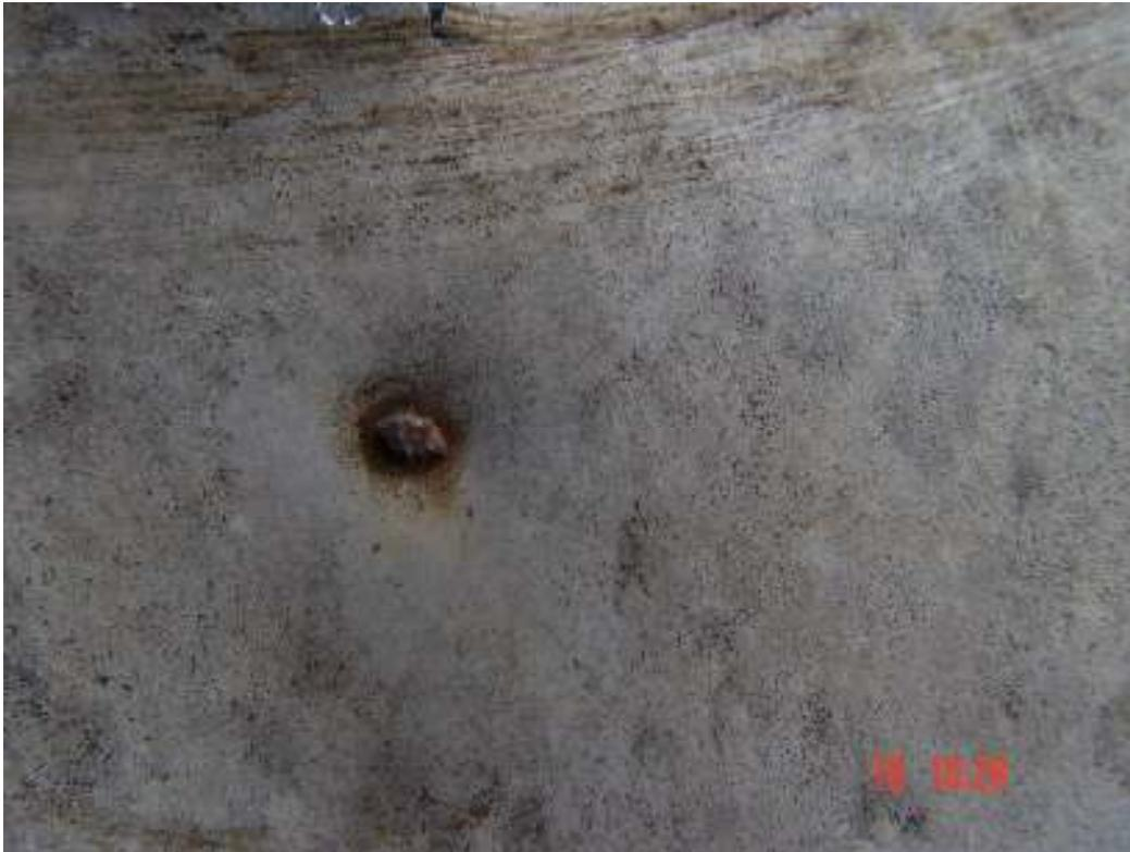
**Fig. 38 : Absorption des fragments dans le panneau (5)**
