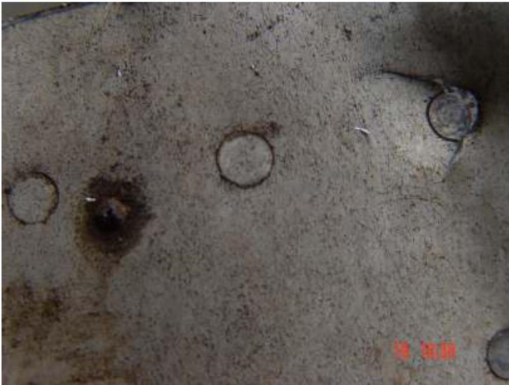
**Fig. 35 : Absorption des fragments dans le panneau (2)**
