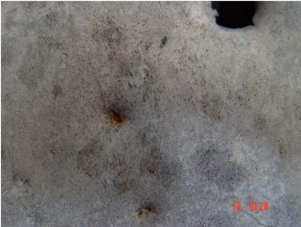
**Fig. 37 : Absorption des fragments dans le panneau (4)**
