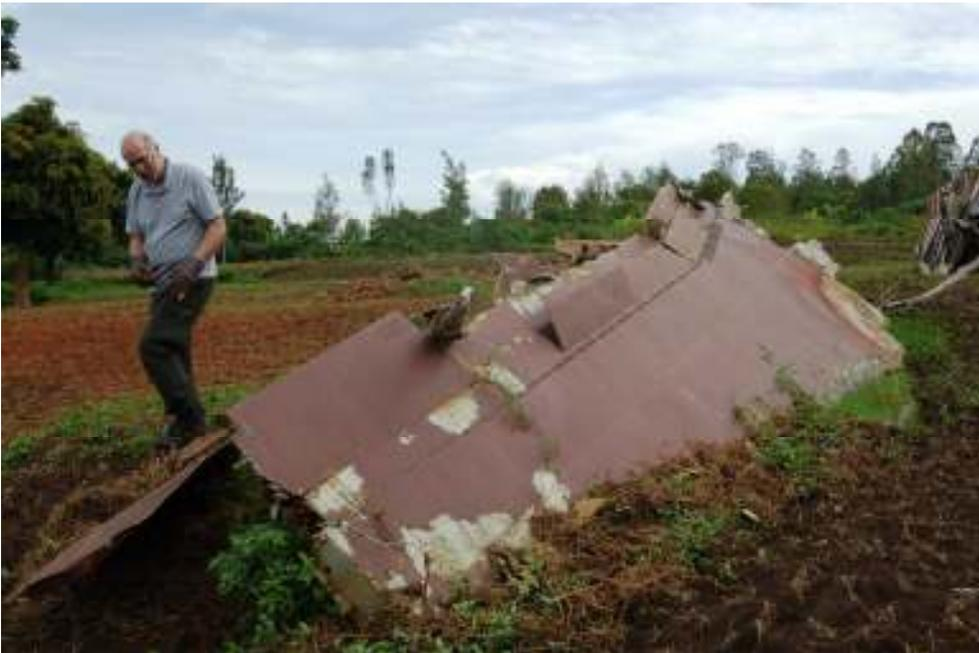
**Fig. 12 : Aile droite et partie arrière de l'aile gauche (3).**
