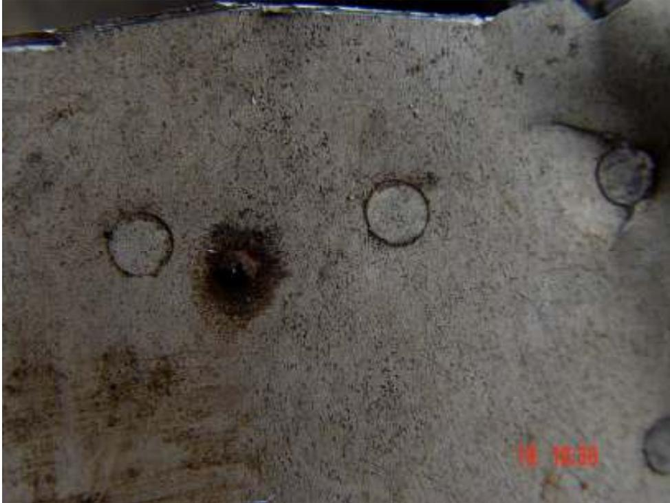
**Fig. 34 : Absorption des fragments dans le panneau (1)**
