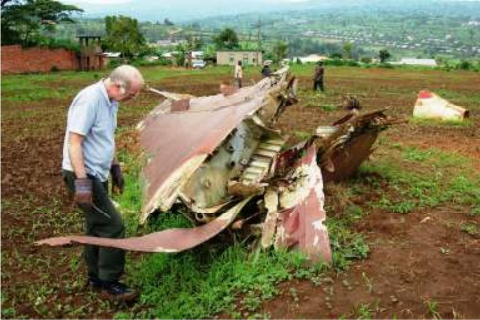
**Fig. 11 : Aile droite et partie arrière de l'aile gauche (2).**
