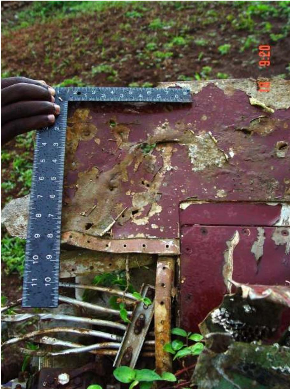
Fig. 23 : Partie arrière de l'aile gauche (2).
