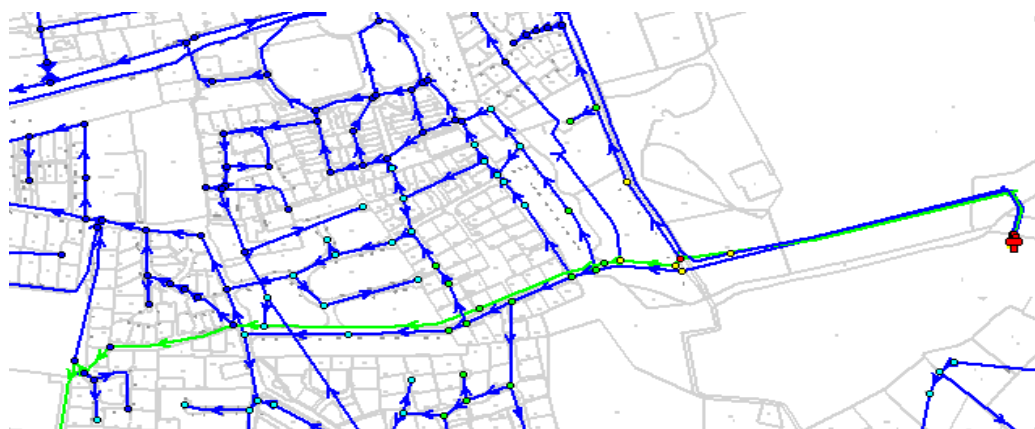
Figure 1 – Réseaux sous EPANET
