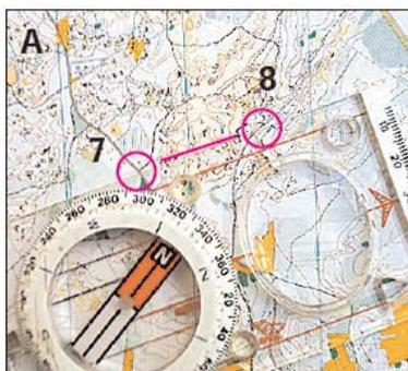
**A.** Placez la boussole sur la carte de manière à faire coïncider son arête longitudinale avec le trait reliant le poste 7 au poste 8. La flèche de direction de la boussole doit indiquer la direction 7-8.
