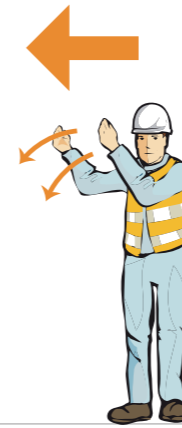
Déplacement support de grue
