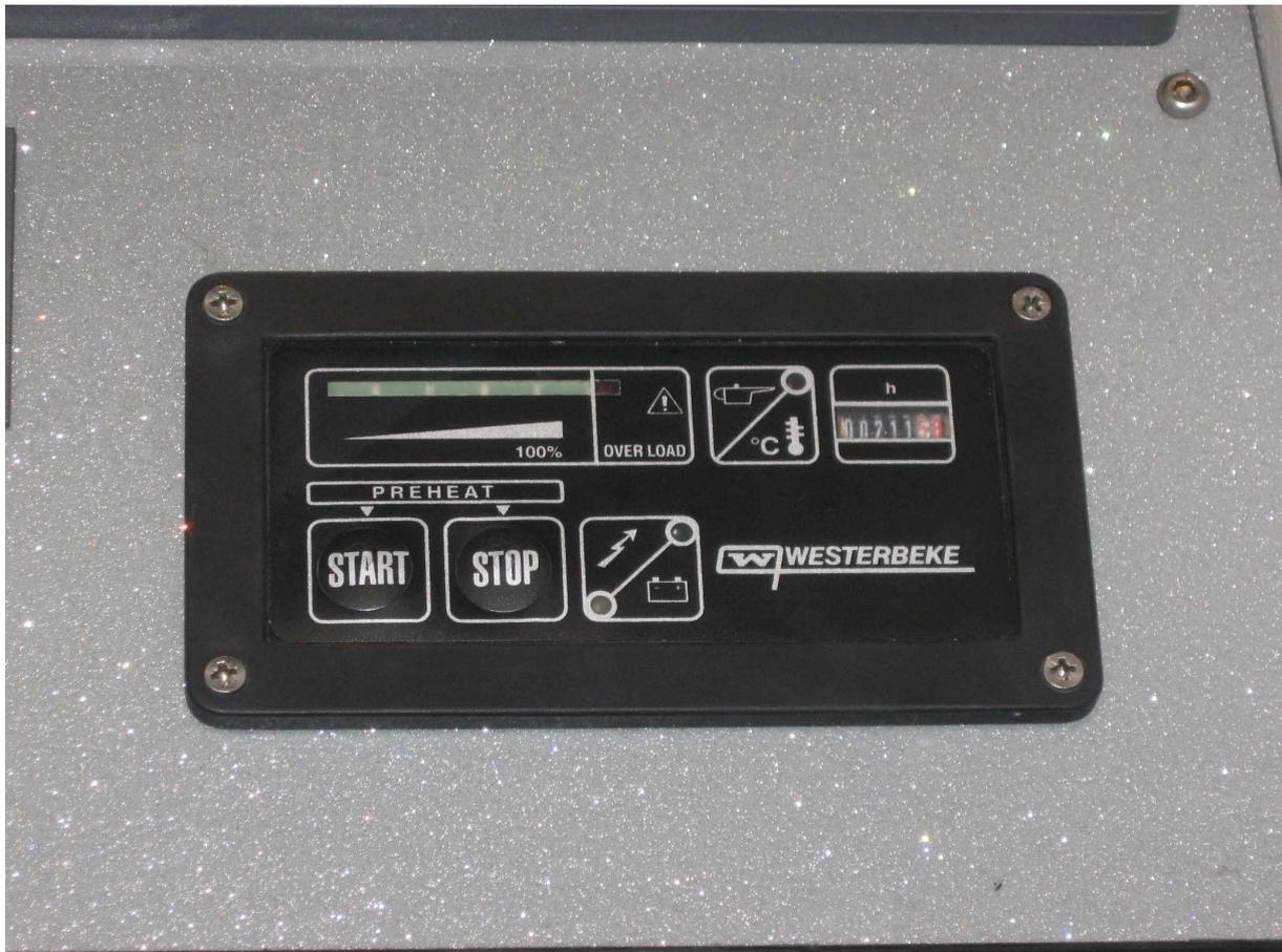
Préchauffer qqs secondes (15 à 30 selon température ambiante) en maintenant enfoncées les touches START et STOP
