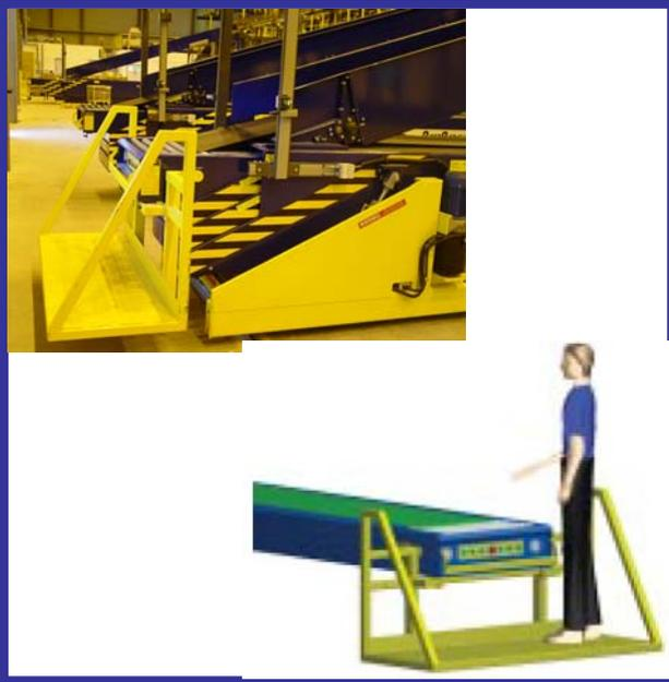
La nacelle opérateur maintient l'opérateur au niveau des charges pour une manutention ergonomique à tous les niveaux du chargement.
