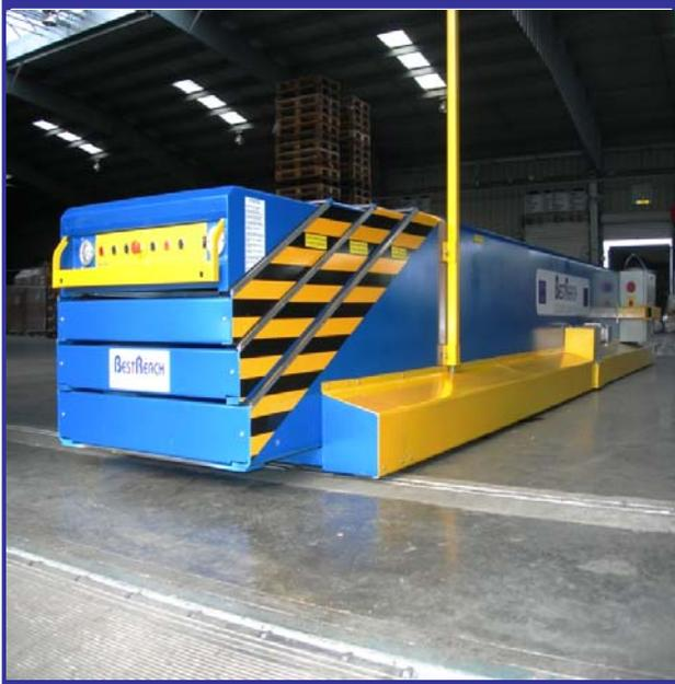
La translation motorisée sur rails est une configuration permettant au convoyeur télescopique à bande d'effectuer un mouvement transversal.
