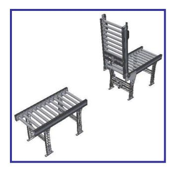
Le transporteur portillon à rouleaux libres permet d'offrir en milieu de ligne de convoyage un passage d'opérateur ou de chariots de manutention.
