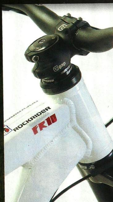
La douille de direction en 1.5" assure une grande rigidité de la partie avant.
