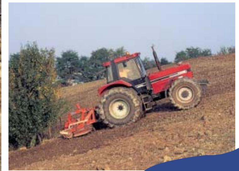
Le décompactage profond est à éviter lorsqu'on crée des zones humides superficielles alimentées latéralement ou par les eaux de pluie : on ne cherche pas à rendre le substrat profond plus perméable ; si en revanche, on attend une alimentation par la nappe, le décompactage peut être souhaitable.
