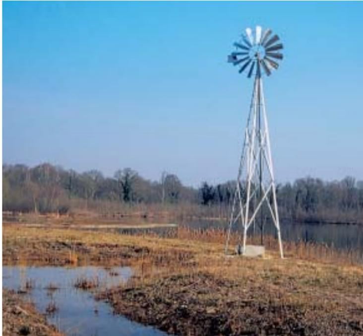
**Photo 60.** Cette éolienne, construite dans le cadre d'un aménagement de carrière, permet une gestion hydraulique du site (Écosphère – M. Pajard).
