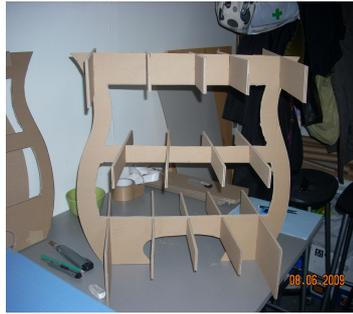
Pour éviter les erreurs, glisser au fur et à mesure les traverses réalisées dans leur encoche.
