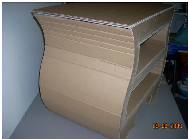
Il faut maintenant fermer les côtés de votre meuble. Utilisez un mètre ruban pour vos mesures, prévoir un peu plus large, (possibilité de poncer). Couper des bandes de carton (cannelure apparente en façade). Maintenir la plaque avec des morceaux de kraft ou les coller au pistolet à colle.
