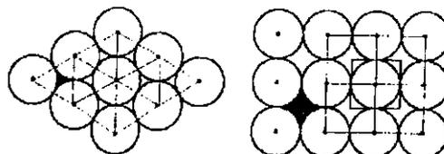
L'arrangement hexagonal de disques (par exemple des pièces de monnaie) minimise l'encombrement. On peut ici le comparer à un arrangement en carré.
