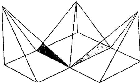
On veut créer le dispositif suivant permettant de reconstituer un cube.
