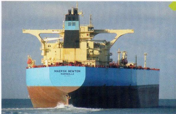
**1** Un superpétrolier de la compagnie Maersk loué par Total. Un système de double coque permet d'éviter que le pétrole ne se déverse dans la mer en cas d'accident.
