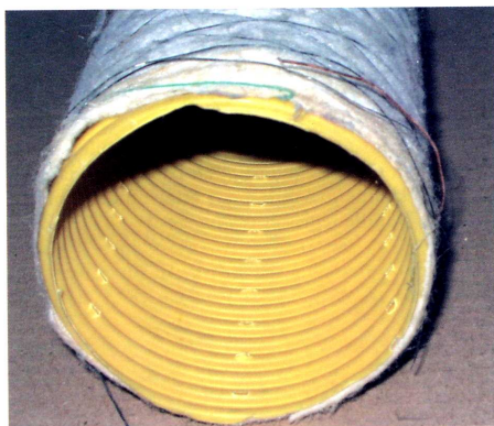
Photo n° 12 : drain souple annelé enrobage géotextile synthétique (photo CETE Nord - Picardie / LRPC)
