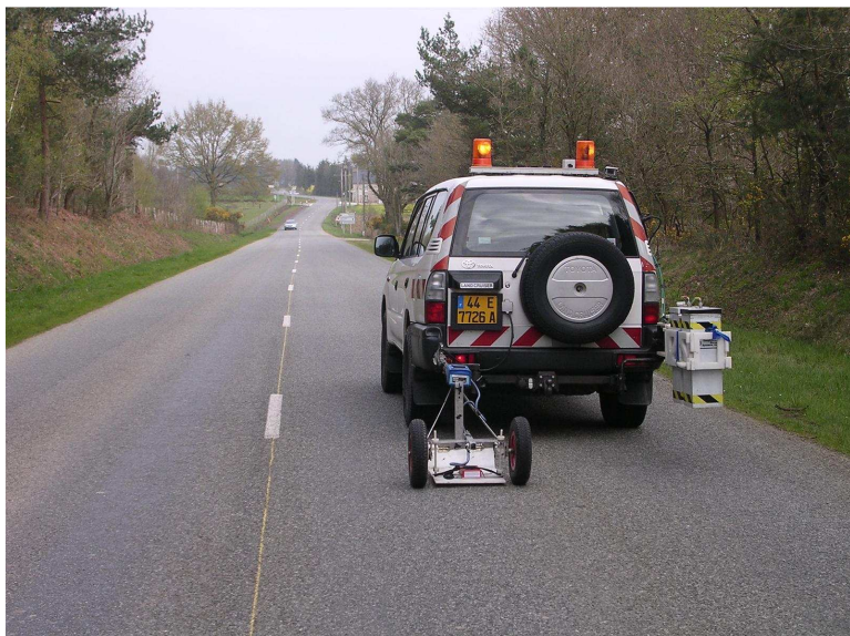
Radars pour mesures longitudinales, à gauche antenne de contact de 900 MHz, à droite antenne aérienne de 2 GHz
