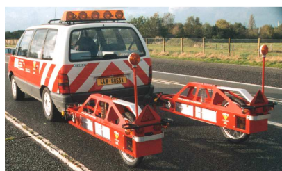
Analyseur de profil en long
