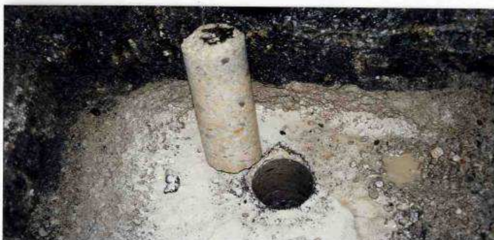
Opération de carottage sur une structure inverse
