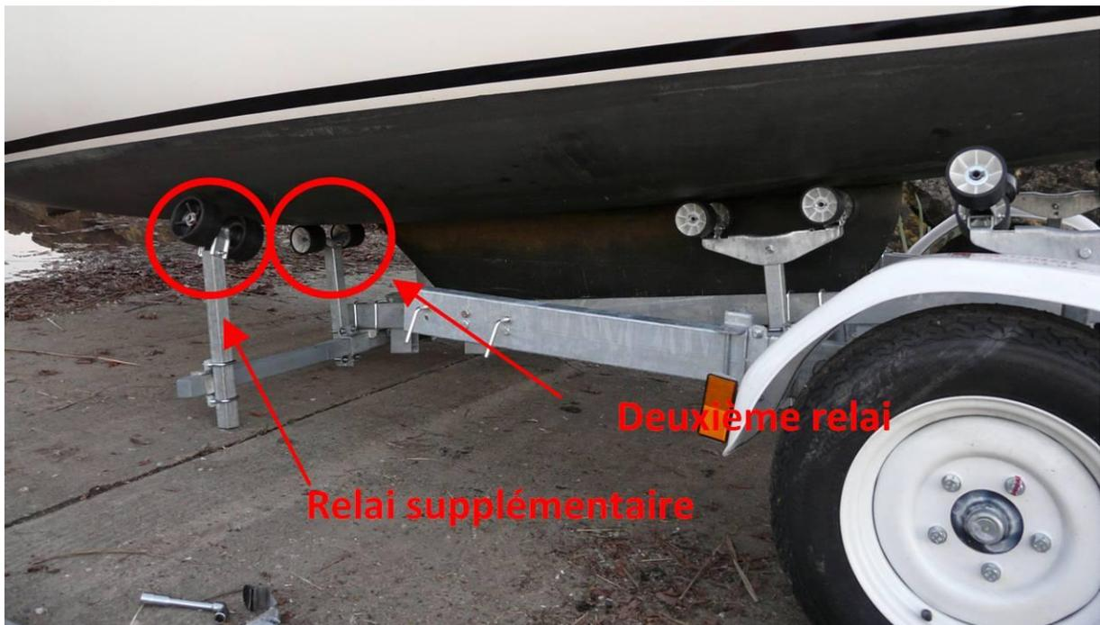
J'ai jugé utile d'« élargir » le relai de bout de rampe par un relai supplémentaire, car lorsque la poupe du bateau commence à flotter, la stabilité latérale n'est pas suffisamment assurée par ce que j'appelle « deuxième relai » du fait du peu de largeur d'appui sur la coque.
