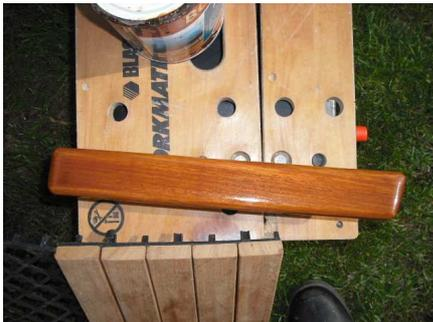
Après avoir pris les cotes, il suffit de fixer ces « lames » de chaque côté de l'entrée. Les fixations se font par l'intérieur avec des vis à bois inox
