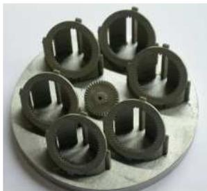
La fabrication additive de poudres métalliques est une technologie novatrice pour l'obtention de pièces de formes complexes, sans limite de géométrie. Elle offre une solution alternative lorsque les moyens de fabrications classiques ne permettent plus de répondre économiquement au développement d'un produit.
