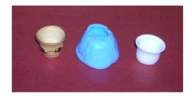
Fabriquer un moule avec de la pâte silicone en se servant d'un modèle quelconque.
