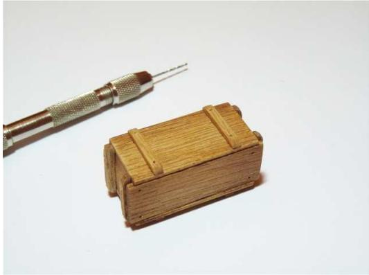
Percer 24 trous (en façade, au dos, sur le couvercle et sur le fond, sur les traverses de côtés) afin de simuler l'emplacement des clous.
