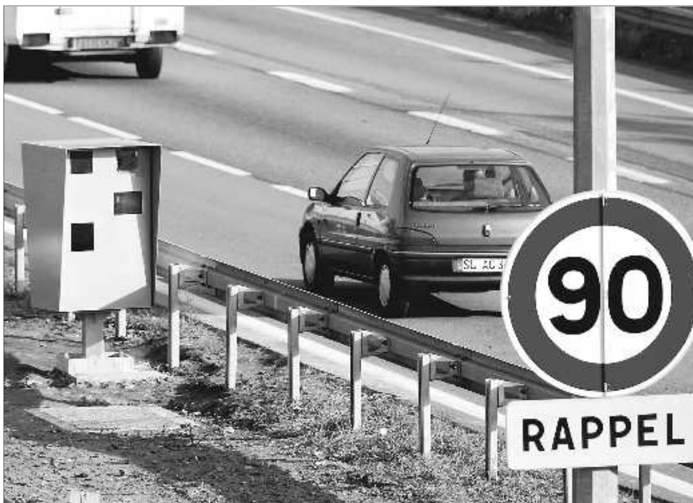
Pour les radars déjà en service, l'erreur maximale tolérée est de 5 km/h pour une vitesse inférieure à 100 km/h. Elle est de plus ou moins 3 km/h pour les instruments neufs ou réparés.
