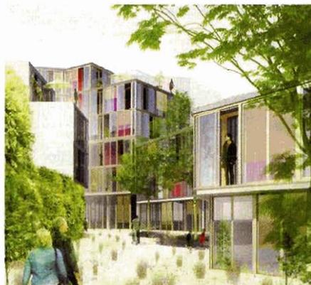
Des murs en béton dans une double peau en verre vont capter la chaleur pour la rediffuser.
