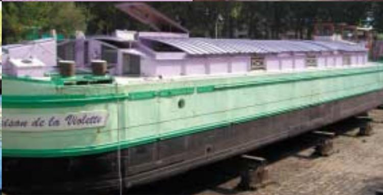
Tous les 2 ans, au mois de janvier, la Péniche lève l'ancre pour rejoindre la cale sèche située à 3kms environ. Cette embarcation longue de 28,5 mètres, pèse 100 tonnes. Elle repose sur des poutres métalliques ce qui permet de faire les travaux de nettoyage, d'expertise et de peinture sous la sole
