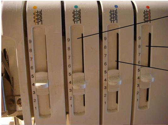
Tension du fil de l'aiguille droite, ici pas d'aiguille gauche
