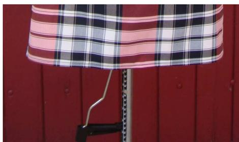
Un tube dont une extrémité est une poire, soufflant de la craie en poudre, grâce à une base horizontale sur un pied dont on fixe la hauteur (pas mal dit, non ?)
