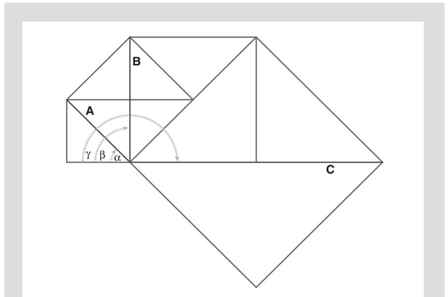
**Figure 3.** Le principe « d'élever au carré » se traduit par le doublement de l'angle de rotation et l'élévation au carré de la longueur. L'angle  $\beta$  est le double de l'angle  $\alpha$ . L'angle  $\gamma$  est le double de l'angle  $\beta$ . De plus, la longueur de B est le carré de la longueur de A, et la longueur de C est le carré de la longueur de B.
